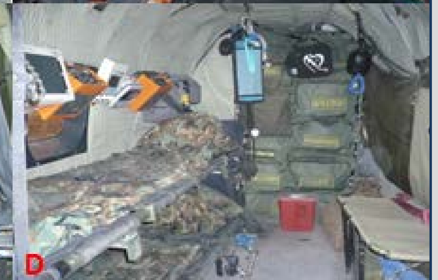
Evolución del AS-332 español en Afganistán. Ventiladores de transporte, monitores de constantes, botella de oxígeno, bomba de perfusión, DESA, mochilas medicalizadas.
