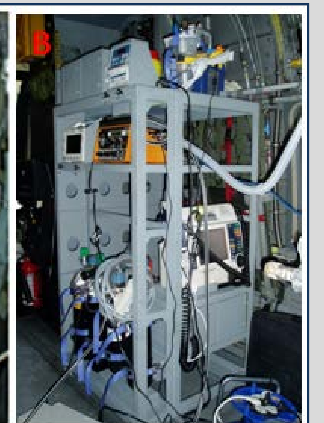
Armario metálico para los dispositivos de electromedicina (aspirador de secreciones, bomba de perfusión, monitor de constantes, ventilador mecánico de transporte, desfibrilador y botellas de oxígeno). Su anclaje al mamparo de la aeronave se consiguió mediante cinchas.
