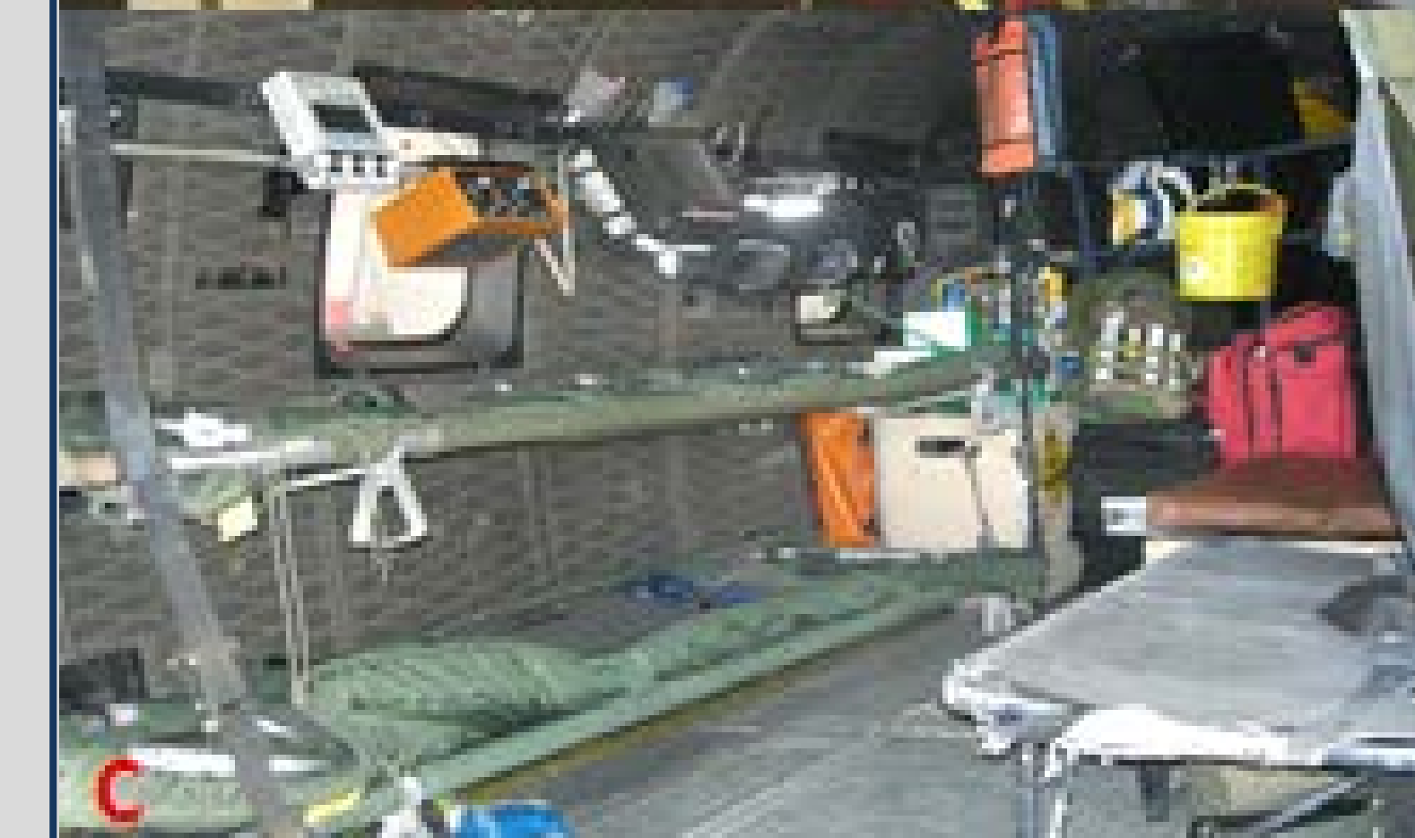
Evolución del AS-332 español en Afganistán. Ventiladores de transporte, monitores de constantes, botella de oxígeno, bomba de perfusión, DESA, mochilas medicalizadas.
